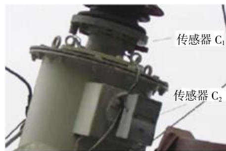
图7 安装于220 kV电力变压器的双电流传感器
